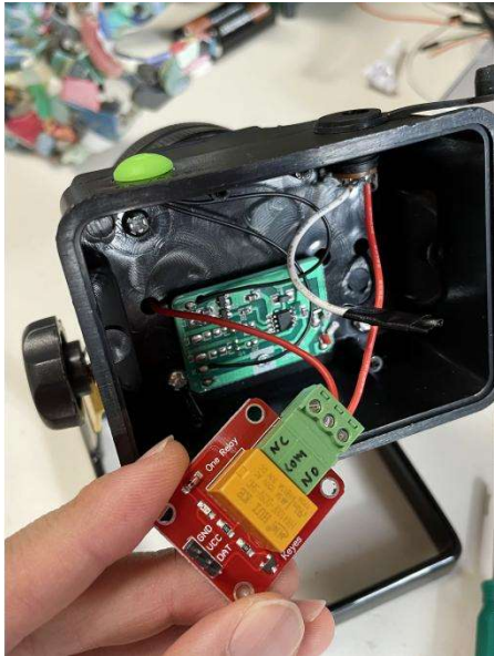
圖 10 | (左) 透過 Serial Port 溝通，將 Three.js 動畫程式與 Arduino 晶片對接 圖 11 | (右) 探照燈電路改作：加入繼電器以接收 Arduino 控制訊號
