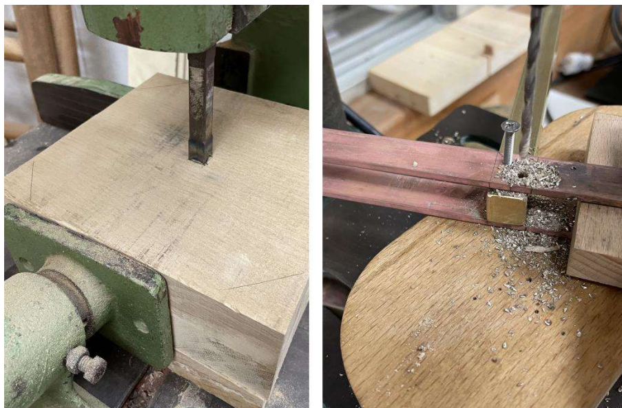
圖 6 | (左) 木作底座製作：使用角鑿刀在膠合後的三片白橡木中央鑿方形孔 圖 7 | (右) 金屬支撐架製作：焊接與鑽孔，作為固定海廢塑料雕塑的支撐結構
