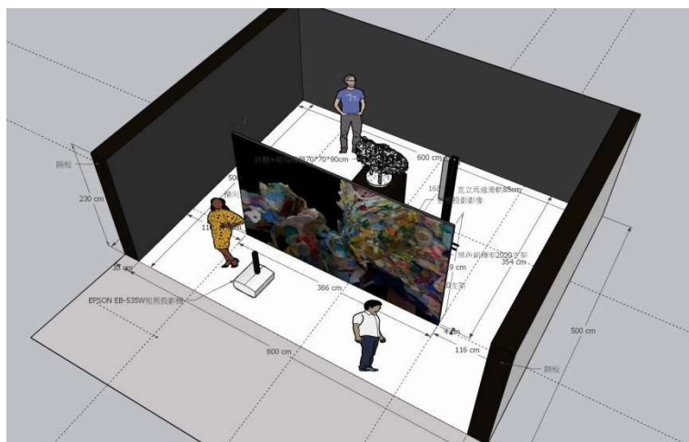
圖 23 | 〈海廢塑料頭骨—其生成、流動與綿延〉空間規劃設計，筆者繪製
