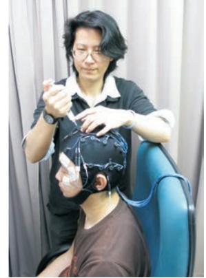
實驗設備包括由美國 Neuroscan 公司研發的兩個系統：生理訊號記錄系統 (Physiological Data Record System) 與視覺影像呈現系統 (Visual Image Display System)。生理訊號記錄系統包含：依照國際 10-20 制 (international 10-20 system) 所紀錄的 32 Ag/AgCl 電極帽 (Quik-Cap)、放大器 (NuAmps) 及電腦主機 (需安裝 SCAN 4.4 軟體)。視覺影像呈現系統包含：17 吋液晶螢幕、鍵盤及電腦主機 (需安裝 STIM2 軟體)。
